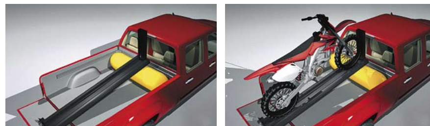
Ilustração exemplifica processo de instalação da motocicleta na calha com sistema de articulação
